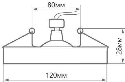
Элегантный встраиваемый светильник CD4033 украсит интерьер и предоставит возможность дополнительной подсветки помещения. Светильник подсвечивается встроенными в корпус светодиодами, что позволяет увидеть красоту светильника во включенном состоянии. Светильник может устанавливаться как в подвесные, так и в натяжные потолки. Светильник оборудован драйвером для подключения светодиодной подсветки для прямого включения в сеть 230V и в качестве основного источника света используются лампы GX53.
